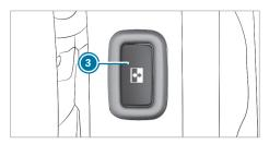
Sliding door button on the door frame (B-pillar)
