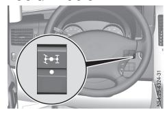
► To engage/disengage: press the → button.
