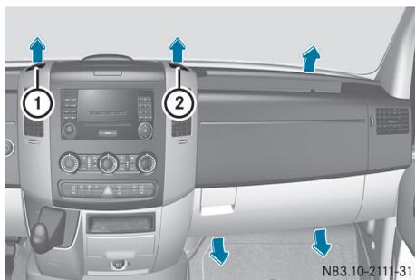
Bouches d'air (exemple: côté droit du véhicule)
