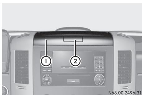
Compartment de rangement avec couvercle au-dessus de la console centrale
