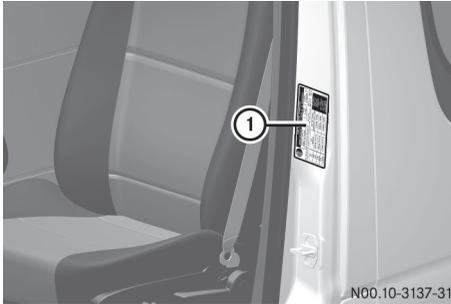
L'étiquette d'information sur les pneus et la charge du véhicule sur le montant B de la porte conducteur.
