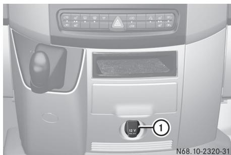
Prise dans la section inférieure de la console centrale
