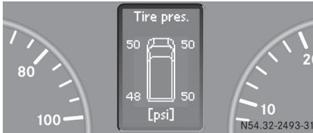
Si le véhicule est stationné plus de 20 minutes et qu'il n'est subséquent pas conduit à plus de 30 km/h (18 mi/h), le message suivant sera affiché :
