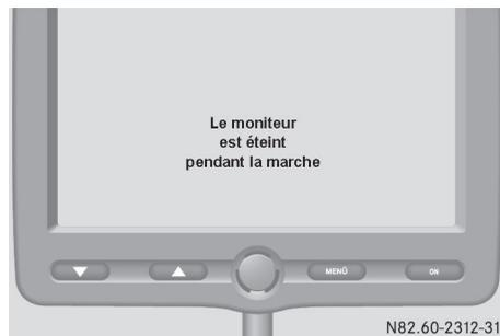
Lorsque la vitesse chute à moins de 8 km/h (5 mi/h), le moniteur se remet en fonction.
