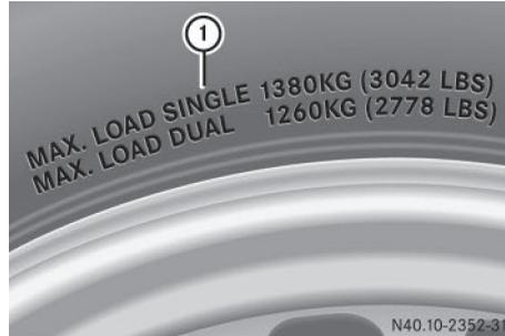
Charge maximale du pneu (exemple)
