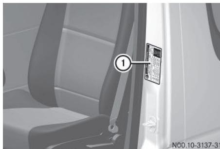
Plaque d'information sur les pneus et le chargement située sur le montant B côté conducteur (exemple)
