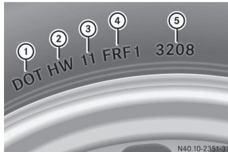
Le numéro d'identification du pneu est univoque. Le numéro d'identification du pneu permet aux fabricants de pneus ou aux entreprises de rechapage d'informer plus facilement les acquéreurs d'éventuelles campagnes de rappel et de
