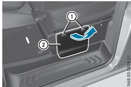
Compartiment de rangement dans le caisson du siège avant gauche
