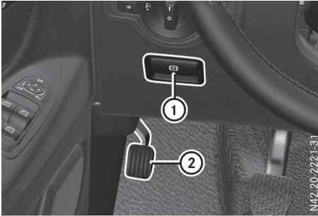
Lorsque vous freinez le véhicule avec le frein de stationnement, les feux stop ne s'allument pas. Vous ne devez en principe serrer le frein de stationnement que si le véhicule est à l'arrêt.
