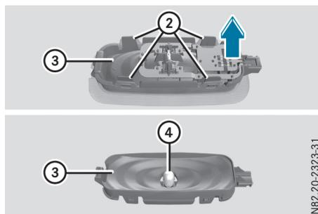
Type d'ampoule : T10 6W Xenon
