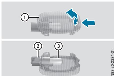
Type d'ampoule : W 5 W
