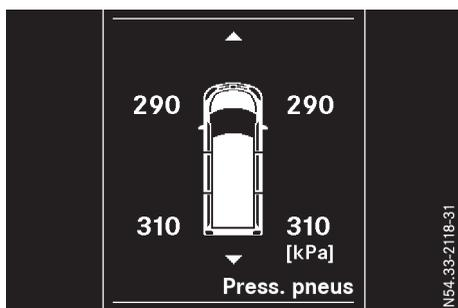
Affichage de la pression des pneus (uniquement sur les véhicules équipés d'un volant multifonction)
