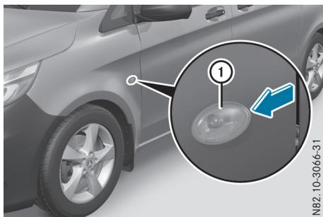
Les clignotants additionnels se trouvent sur le côté, au niveau des ailes avant du véhicule.
