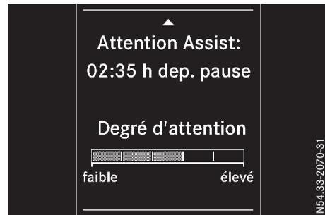
Sur les véhicules équipés d'un volant multifonction, vous pouvez afficher l'évaluation actuelle du système ATTENTION ASSIST (degré d'attention).
