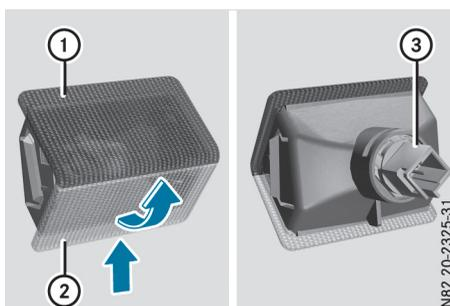
Type d'ampoule : W 5 W
