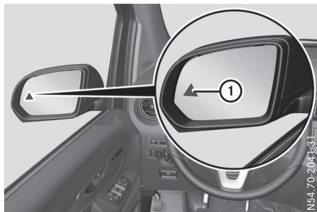
L'avertisseur d'angle mort ne fonctionne pas en dessous de 20 mph (30 km/h) environ. Dans ce cas, les véhicules qui se trouvent dans la zone de surveillance ne sont pas affichés.
