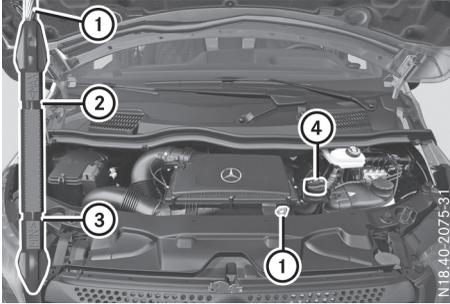
Jauge à huile et orifice de remplissage de l'huile moteur
