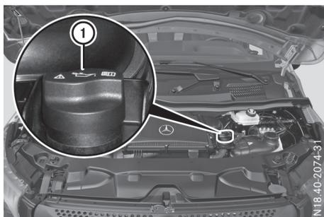
Orifice de remplissage de l'huile moteur (exemple)
