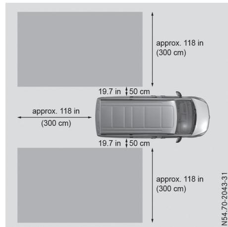
La zone surveillée par l'avertisseur d'angle mort est représentée sur l'illustration. Elle s'étend jusqu'à 118 in (3 m) derrière le véhicule et sur les côtés.
