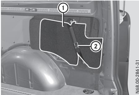
Support pour outils dans le compartiment de chargement, sur le côté droit du véhicule
