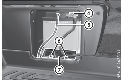
Caisson de siège ouvert avec batterie montée (exemple : siège avant droit)
