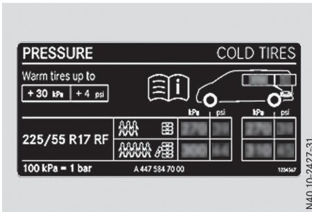
Tableau des pressions de gonflage situé dans la trappe du réservoir du combi (exemple)
