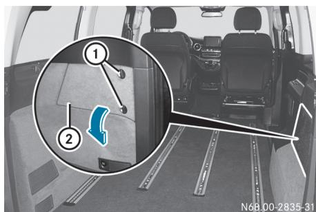
Compartment de rangement situé à l'arrière, du côté droit du véhicule
