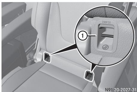
① Etriers de fixation ISOFIX (schéma de principe)
