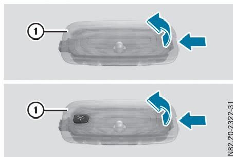
Plafonnier arrière et éclairage du compartiment de chargement dans la garniture du toit ou latérale
