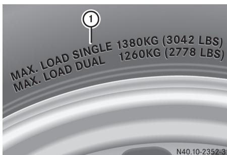
Charge maximale du pneu (exemple)
