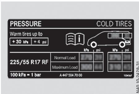
Tableau des pressions de gonflage situé dans la trappe du réservoir du fourgon (exemple)
