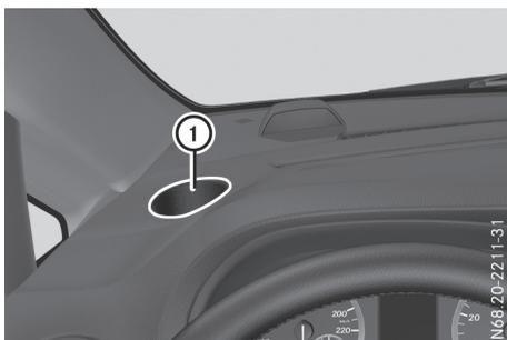
Porte-gobelets dans la planche de bord (exemple: côté gauche du véhicule)
