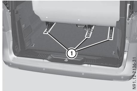
Système de glissières de siège avec verrouillage rapide (exemple)
