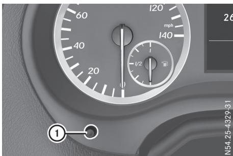
Variateur de luminosité (exemple : véhicules équipés d'un volant multifonction)
