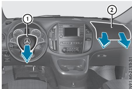
L'airbag frontal du conducteur ① se déploie devant le volant. L'airbag frontal du passager ②
