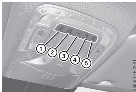
Touches de commande de l'éclairage intérieur (exemple : unité de commande au plafonnier confort)
