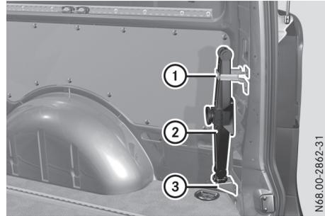
Support pour cric dans le compartiment de chargement, sur le côté droit du véhicule
