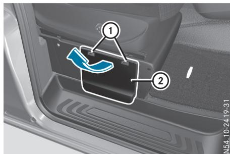
Caisson de siège (exemple: siège avant droit)
