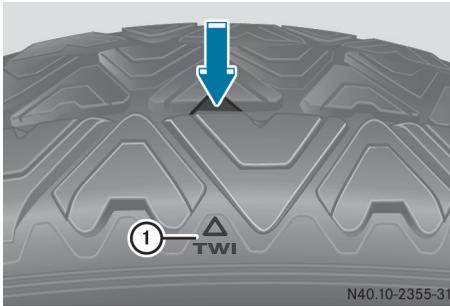
Le repère ① indique l'emplacement auquel l'indicateur (flèche) d'usure de la bande de roulement, qui se présente sous la forme d'une barrette, est intégré dans les sculptures du pneu.
