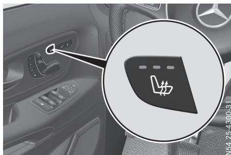
Les 3 voyants rouges incorporés à la touche
