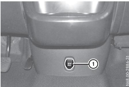
Lorsque la clé se trouve en position **1** dans le contacteur d'allumage, vous pouvez utiliser les prises pour alimenter des accessoires dont la puissance n'est pas supérieure à 180 W (15 A). La batterie de démarrage peut se décharger lorsque le moteur est arrêté et que les prises sont très longtemps utilisées. Si la tension de bord est trop faible, il se peut que vous ne puissiez plus démarrer le moteur.
