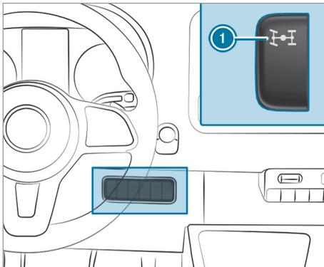
► **Enclenchement et désenclenchement :** appuyez sur le haut du contacteur ①. Le voyant incorporé au contacteur ① clignote pendant que la transmission intégrale est enclenchée ou désenclenchée.
