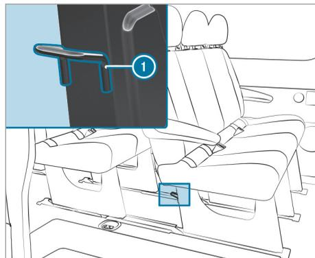
Les points d'ancrage Top Tether
