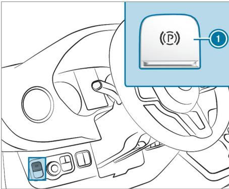
Pour empêcher le serrage automatique du frein de stationnement électrique, tirez le contacteur ❶.
