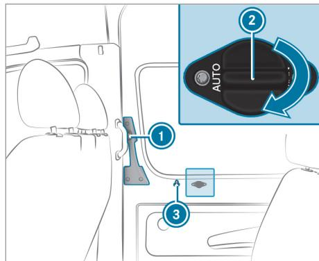
Si un défaut est survenu ou si la batterie est débranchée, vous pouvez désaccoupler la porte coulissante du moteur électrique à l'aide du contacteur de coupure **2**. Vous pouvez ensuite ouvrir ou fermer manuellement la porte coulissante.
