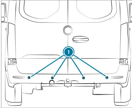
Certains systèmes d'aide à la conduite et systèmes de sécurité active surveillent à l'aide de capteurs ❶ les environs à l'avant, à l'arrière ou sur les côtés du véhicule (en fonction de l'équipement du véhicule).
