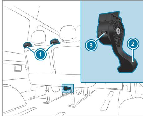
► Abaissez complètement la poignée de déverrouillage ② de la banquette et maintenez-la dans cette position. Simultanément, basculez légèrement la banquette vers l'arrière à l'aide de la poignée de déverrouillage et la tirez légèrement vers l'arrière.
