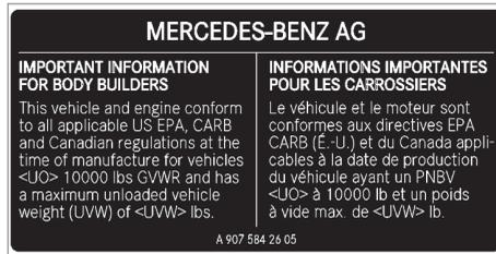
La plaque carrossier se trouve sur le radiateur du module de face avant et comprend le poids à vide maximal autorisé pour les véhicules.
