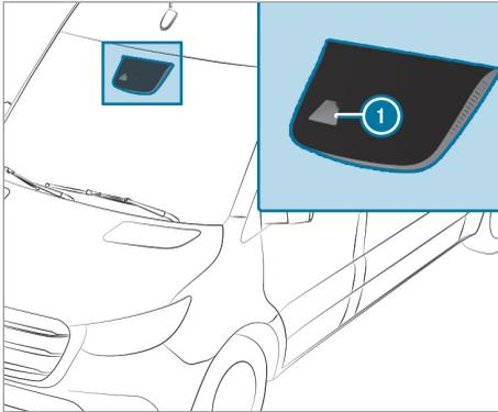
L'avertisseur de franchissement de ligne surveille la zone située devant votre véhicule à l'aide d'une caméra multifonction ①. Il sert à vous préserver d'un changement involontaire de voie. Pour cela, le système peut vous avertir par une sensation perceptible au niveau du volant ou par un signal d'alerte et le clignotement du symbole d'état sur l'écran pour les instruments.
