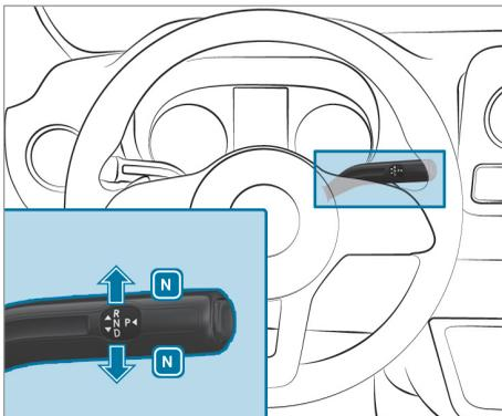
▶ Appuyez sur la pédale de frein et actionnez le levier sélecteur DIRECT SELECT vers le haut ou vers le bas jusqu'au 1er point de résistance. L'affichage de la position de la boîte de vitesses sur l'écran multifonction indique **N**.
