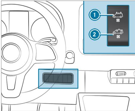
Si votre véhicule est équipé d'un aérateur de toit, vous pouvez ventiler et aérer le compartiment de chargement.
