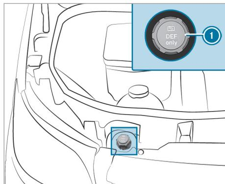
▶ Après avoir rempli le réservoir d'AdBlue®, mettez le bouchon du réservoir d'AdBlue® ① en place sur la tubulure de remplissage et serrez-le à fond en le tournant vers la droite.
