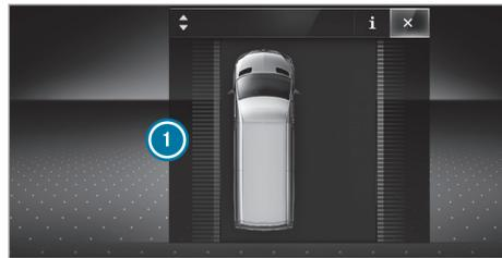
Lorsqu'une intervention de freinage permettant de revenir sur la voie empruntée a lieu par l'intermédiaire de l'assistant de franchissement de ligne actif, l'affichage (1) apparaît sur l'écran multifonction.
