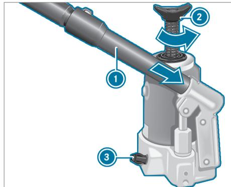
▶ **Préparation du cric hydraulique :** emboîtez la 3e tige du levier de pompe ① du cric sur la rallonge de la clé démonte-roue.
