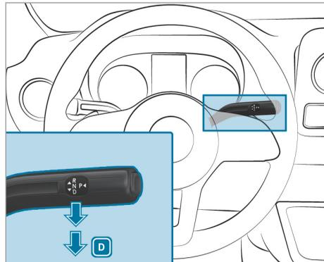
▶ Appuyez sur la pédale de frein et actionnez le levier sélecteur DIRECT SELECT vers le bas au-delà du 1er point de résistance. L'affichage de la position de la boîte de vitesses sur l'écran multifonction indique **D**.
