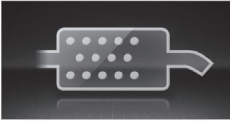
Affichage d'un filtre à particules diesel saturé à 75%
