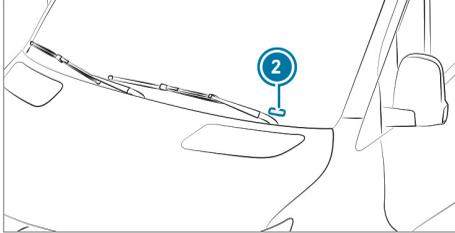
Le VIN figure également sur une plaque située sur le bas du pare-brise ❷.
