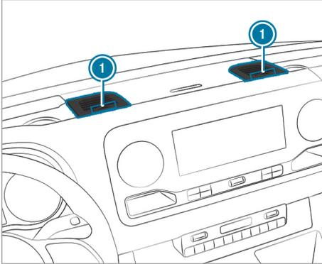
► **Ouverture et fermeture :** tournez la molette de réglage ① au niveau des buses à jet long vers la gauche ou vers la droite jusqu'en butée.
