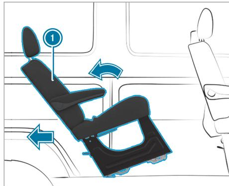
► Basculez la banquette ① vers l'arrière et sortez-la des coques de siège.
