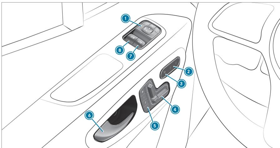
Unité de commande sur la porte des véhicules équipés de sièges à réglage électrique
