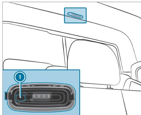
▶ ① Allumage et extinction de l'éclairage intérieur arrière et de l'éclairage de compartiment de chargement
