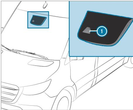
L'assistant de franchissement de ligne surveille la zone située devant votre véhicule à l'aide d'une caméra multifonction ①. Il sert à vous préserver d'un changement involontaire de voie. Pour cela, le système peut vous avertir par une sensation perceptible au niveau du volant ou par un signal d'alerte et le clignotement du symbole d'état sur le combiné d'instruments.
