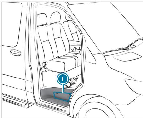
L'outillage de changement de roue se trouve dans le compartiment de rangement **1** situé au-dessus du marchepied de la porte passager et dans le compartiment de rangement situé dans l'espace jambes côté passager.
