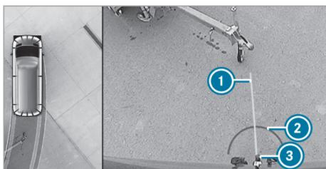
Vue de la remorque (lorsqu'un dispositif pour remorque est monté), avec capteurs arrière
