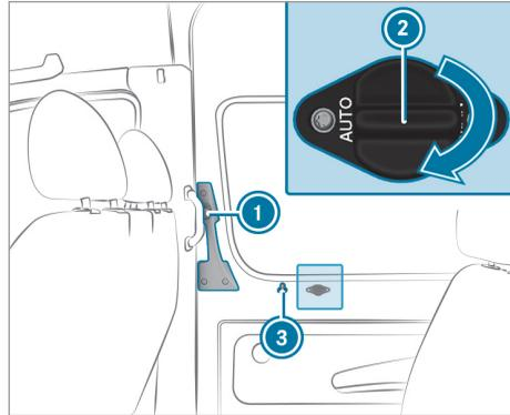
Si un défaut est survenu ou si la batterie est débranchée, vous pouvez désaccoupler la porte coulissante du moteur électrique à l'aide du contacteur de coupure ②. Vous pouvez ensuite ouvrir ou fermer manuellement la porte coulissante .
