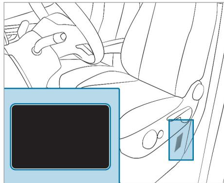
En fonction du type de véhicule, la plaque signalétique du véhicule se trouve sur le caisson du siège conducteur ou sur le montant B.
