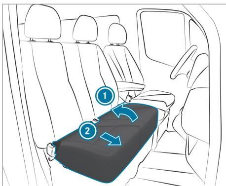
► **Basculement du dossier d'assise vers l'avant :** soulevez le dossier d'assise pour le décrocher des points d'ancrage avant ①.
