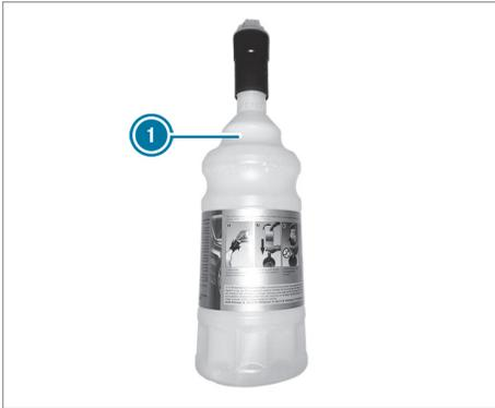
Vous pouvez vous procurer des flacons de remplissage d'AdBlue® ❶ dans de nombreuses stations-service ou dans un atelier qualifié. Les flacons de remplissage sans bouchon fileté n'offrent aucune protection contre le surremplissage. Si vous remplissez trop le réservoir, de l'AdBlue® risque de s'écouler. Mercedes-Benz vous propose des flacons de remplissage spéciaux avec bouchon fileté. Vous pouvez vous les procurer dans un point de service Mercedes-Benz.
