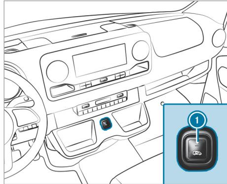
① Ouverture et fermeture de la porte coulissante, côté droit du véhicule
