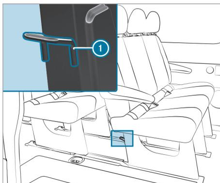
Les points d'ancrage Top Tether ❶ se trouvent au dos de la banquette arrière correspondante, au pied de la banquette.
