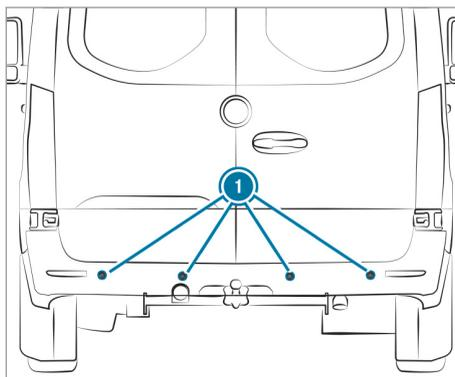
Certains systèmes d'aide à la conduite et systèmes de sécurité active surveillent à l'aide de capteurs ① les environs à l'avant, à l'arrière ou sur les côtés du véhicule (en fonction de l'équipement du véhicule).
