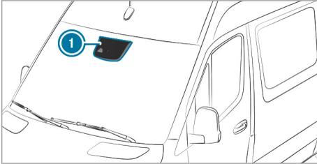
L'assistant de signalisation routière détecte les panneaux à l'aide d'une caméra multifonction ①. Il vous aide en affichant les limites de vitesse et interdictions de dépasser détectées sur le combiné d'instruments.
