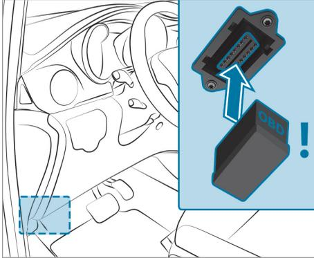
L'utilisation et le raccordement d'un autre appareil à la prise de diagnostic peuvent avoir les conséquences suivantes:
