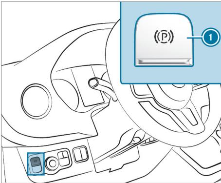
Lorsque l'assistant de régulation de distance DIS-TRONIC actif a immobilisé le véhicule, le frein de stationnement électrique est également serré automatiquement.
