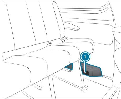
En fonction de l'équipement du véhicule, un canal d'air ou un appareil de chauffage avec buses de ventilation supplémentaires se trouve dans l'espace jambes arrière sur le côté gauche ①. Aucun objet ne doit être placé à cet endroit. Les occupants doivent maintenir une distance suffisante en raison du flux d'air chaud et de l'admission d'air.
