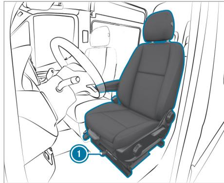
Vous pouvez faire pivoter les sièges conducteur et passager de 50° et de 180°. Les sièges peuvent être verrouillés dans le sens de la marche, dans le sens opposé à la marche et dans un angle de 50° par rapport aux accès.
