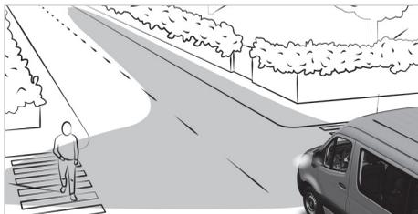
L'éclairage d'intersection augmente considérablement l'angle d'éclairage de la chaussée sur laquelle le véhicule s'engage et permet ainsi de mieux repérer les virages serrés, par exemple.
