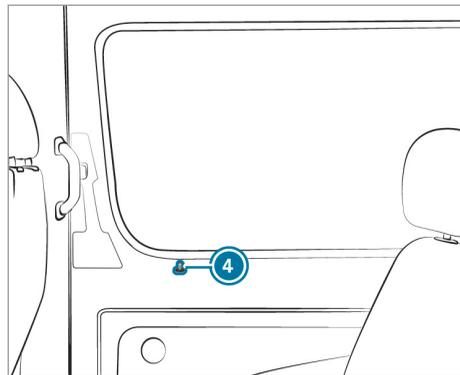
Lorsque la porte coulissante est verrouillée, vous ne pouvez que l'ouvrir de l'intérieur en déverrouillant manuellement le bouton de condamnation ④.
