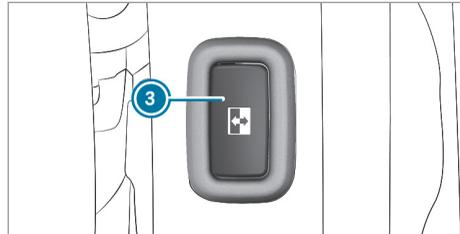
Sur les véhicules équipés d'une cloison de séparation, la touche ③ se trouve sur la cloison de séparation à côté du seuil de la porte et à hauteur de la poignée intérieure de porte.
