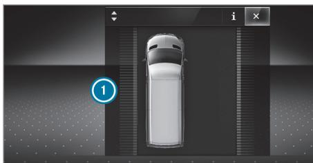
Lorsqu'une intervention de freinage permettant de revenir sur la voie empruntée a lieu par l'intermédiaire de l'assistant de franchissement de ligne actif, l'affichage ① apparaît sur l'écran du combiné d'instruments.
