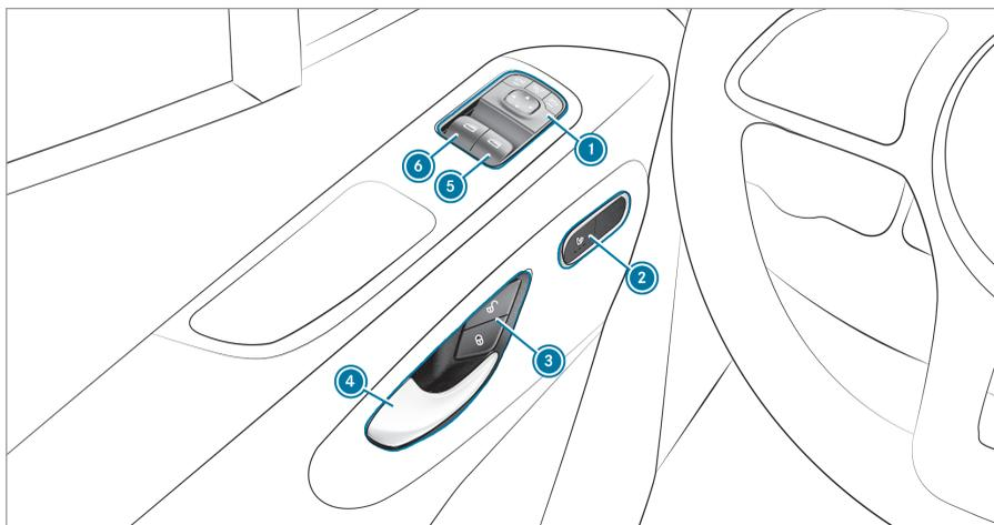
Unité de commande sur la porte des véhicules sans siège à réglage électrique
