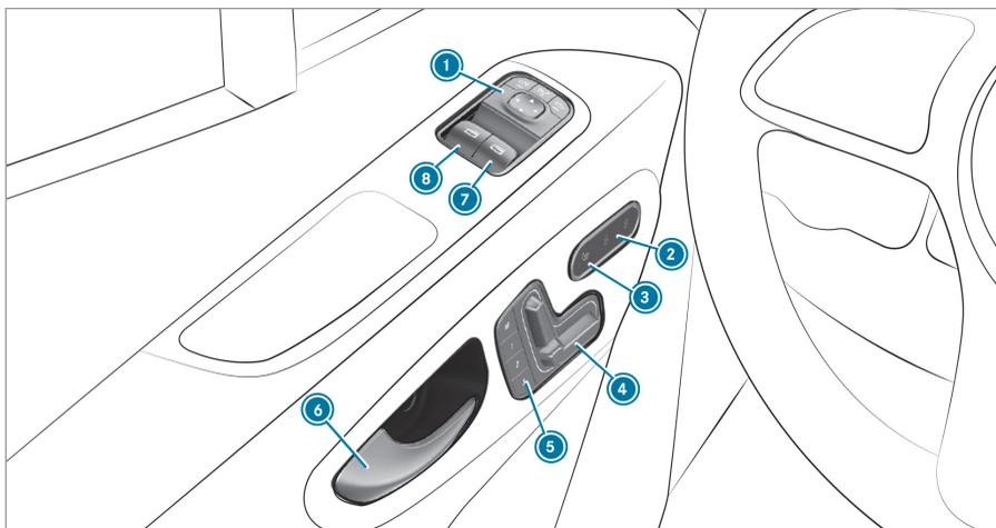
Unité de commande sur la porte des véhicules équipés d'un siège à réglage électrique
