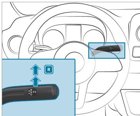
▶ Appuyez sur la pédale de frein et actionnez le levier sélecteur DIRECT SELECT vers le haut au-delà du 1er point de résistance. L'affichage de la position de la boîte de vitesses indique **R** sur le combiné d'instruments.
