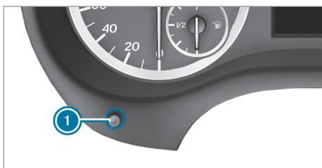
Variateur de luminosité (exemple: véhicule équipé de touches au volant)
