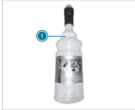
Vous pouvez vous procurer des flacons de remplissage d'AdBlue® (1) dans de nombreuses stations-service ou dans un atelier qualifié. Les flacons de remplissage sans bouchon fileté n'offrent aucune protection contre le surremplissage. Si vous remplissez trop le réservoir, de l'AdBlue® risque de s'écouler. Mercedes-Benz vous propose des flacons de remplissage spéciaux avec bouchon fileté. Vous pouvez vous les procurer dans un point de service Mercedes-Benz.
