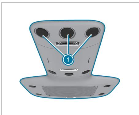
Dans le cas des véhicules équipés d'un climatiseur arrière, des buses de ventilation réglables sont intégrées au toit, dans le canal d'air.
